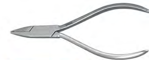
DO.675.300 Jarabak Light wire bending pliers Serrated tips and grooves assure accurate bending and closing of loops Kleszce do doginania drutu Żłobione końcówki z rowkami dokładnie doginają drut i zamykają pętle.
