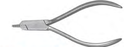
DO.688.300 Nance Loop forming pliers Four steps beak for making precision loops of 3,4,5 or 6mm in round or rectangular wires. One tip is serrated to prevent wire slippage Kleszce do formowania pętli Czterostopniowe dzioby dokładnie formują pętle 3, 4, 5 i 6 mm na łukach okrągłych lub prostokątnych. Jedna końcówka jest żłobiona aby zapobiec wyślizgiwaniu się łuku.
